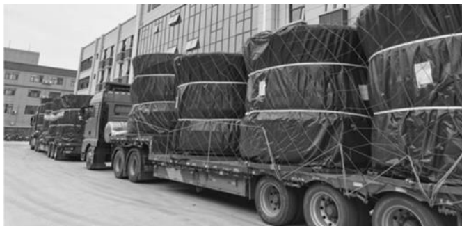
Рисунок 5 – Горизонтальная транспортировка барабанов на автомобиле
