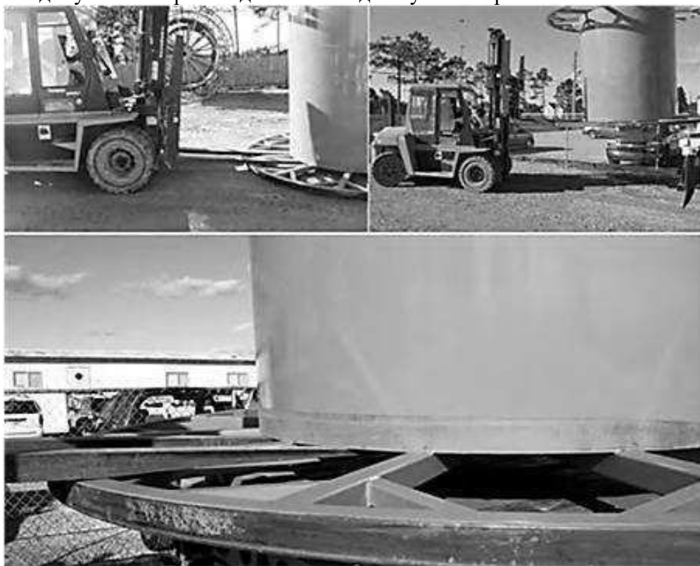
Рисунок 14 – Горизонтальный подъем пустого барабана погрузчиком
